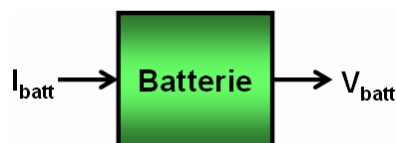
Figure 2.39 : Entrée-Sortie du modèle de batterie
