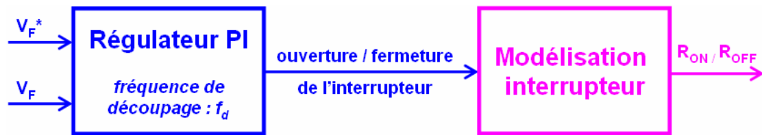
Figure 2.54 : Régulation du convertisseur DC-DC
