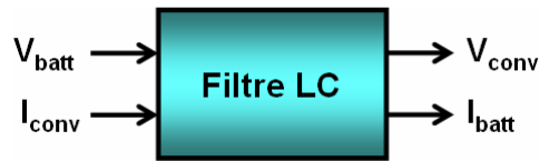
Figure 2.46 : Entrées-Sorties du modèle de filtre LC
