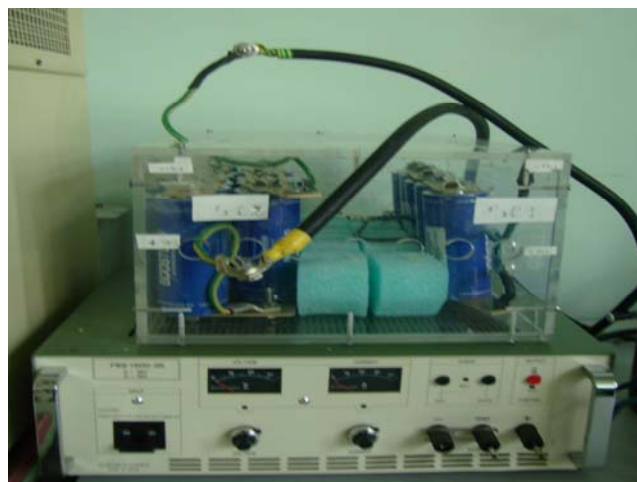
Figure 2-9 : Le module de supercondensateurs (Boostcap) et l'alimentation stabilisée
