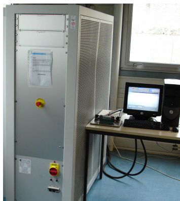
Figure 3.1 : Banc de charge/décharge à forts niveaux de courant
