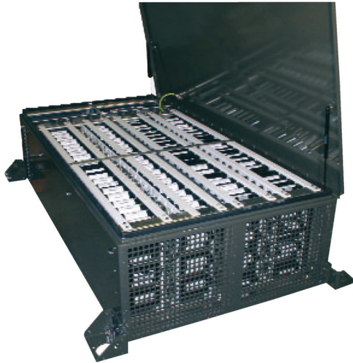
FIG. 3.11 – Photo du stockeur d'énergie "Mitrac Energy Saver" ; Source : [62]
