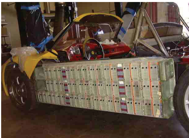
FIG. 3.9 – Pack de batteries de la Tzero ; Source : en.wikipedia.org
