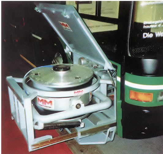
FIG. 3.2 – Photo du volant d'inertie utilisé dans les bus de Bâle ; Source : www.tbuss.org.uk
