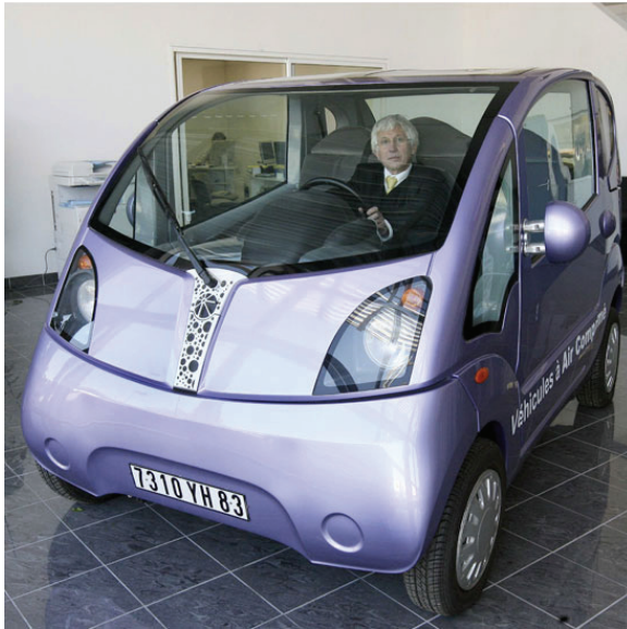
FIG. 3.6 – Photo de la Tata MiniCat, véhicule à air comprimé ; Source : www.zdnet.com
