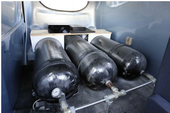
FIG. 3.5 – Photo du réservoir d'air comprimé de la Tata MiniCat ; Source : www.zdnet.com
