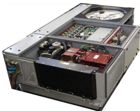
FIG. 3.4 – Photo du volant d'inertie du tramway Alstom Citadis ; Source : [23]
