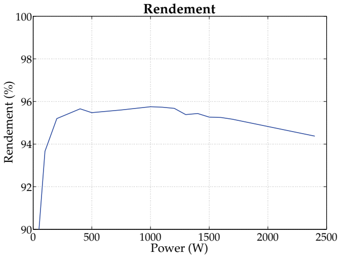
FIG. 7.27 – Rendement mesuré pour un fonctionnement en 4 canaux, U_e = 35V
