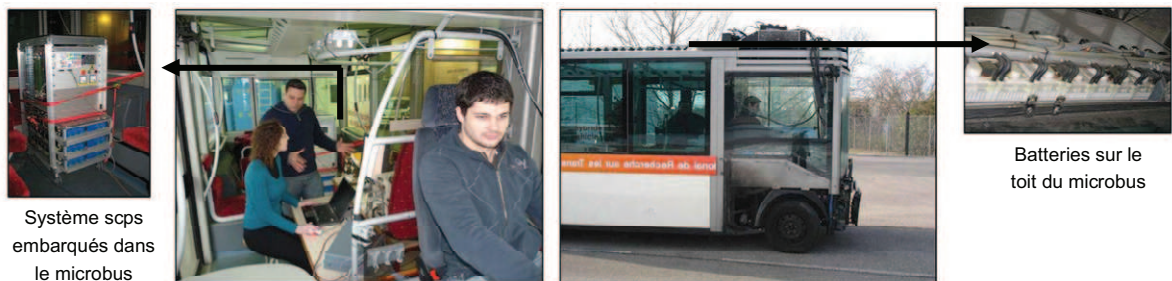
Figure 3-25. Microbus électrique mixte réel disponible au LTE
