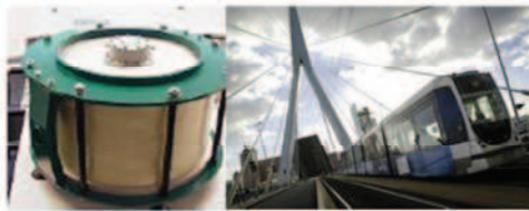
Figure 1-13. Tramway hybride caténaire / volant d'inertie de Rotterdam (www.alstom.com)
