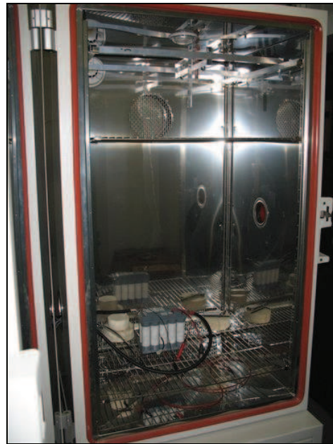
(c) Batterie Ni-MH dans l'enceinte thermique
