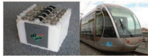
Figure 1-14. Tramway hybride caténaire / batteries Ni-MH de Nice (www.alstom.com)
